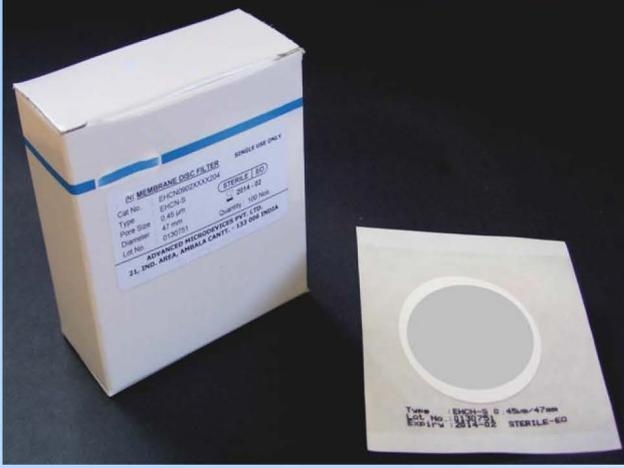
EHCN membranları antibiyotik ve bakteriyostat içeren ilaçların sterilite testi için kullanılır. Membranlarda 6 mm hidrofobik çerçeve mevcuttur. İç kısımdaki membran hidrofilitir.
