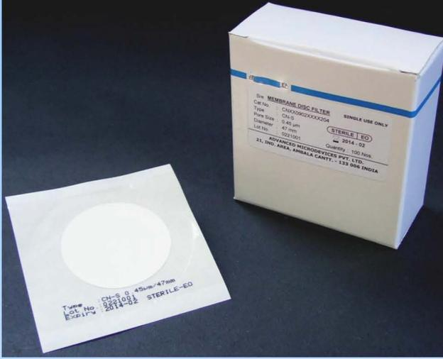
Tip CN ve CN-S (Steril), 47 mm çapında selüloz nitrat membran filtreler olarak sunulmaktadır. Bu filtreler numune hazırlamada, mikrobiyoloji ve filtrasyon çalışmalarında kullanılmaktadır.
